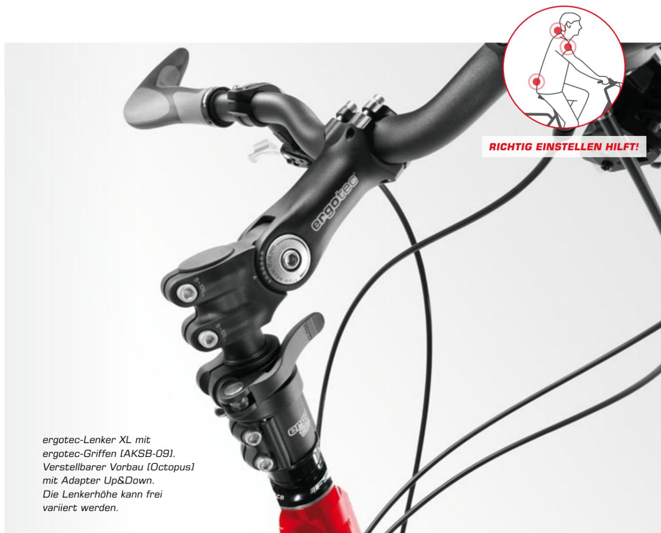
ergotec-Lenker XL mit ergotec-Griffen [AKSB-09]. Verstellbarer Vorbau [Octopus] mit Adapter Up&Down. Die Lenkerhöhe kann frei variiert werden.
