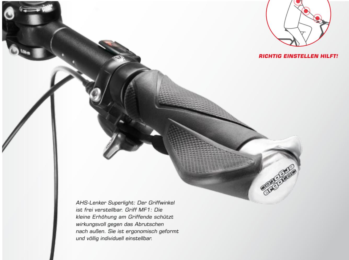
AHS-Lenker Superlight: Der Griffwinkel ist frei verstellbar. Griff MF1: Die kleine Erhöhung am Griffende schützt wirkungsvoll gegen das Abrutschen nach außen. Sie ist ergonomisch geformt und völlig individuell einstellbar.
