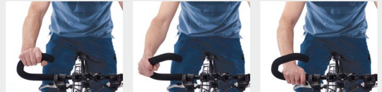
Ideal für „dynamisches Fahren“ sind **Multipositionslenker**. Die geschwungenen Lenkerenden der sogenannten Hornlenker bieten den Händen ganz verschiedene Griffoptionen. Die aktive Abwechslung mit unterschiedlicher Anspannung ist für die Hände, die Arme und den Rücken auf einer längeren Fahrt pure Erholung.
