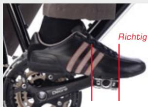
Beim Fahren und Pedalieren steht der Vorderfuß auf dem Pedal – exakt: der Fußballen auf der Pedalachse.
